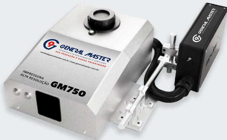
A GM750 é uma impressora jato de tinta de alta resolução com 180 DPI, que permite imprimir informações de codificação e marcação de alta qualidade em uma variedade de materiais de embalagem, tudo em alta resolução.
